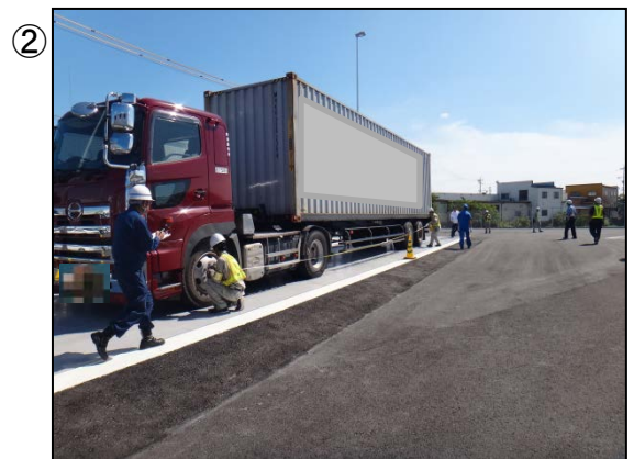
② 車両寸法の測定 (平成28年7月7日:愛知県弥富市)
