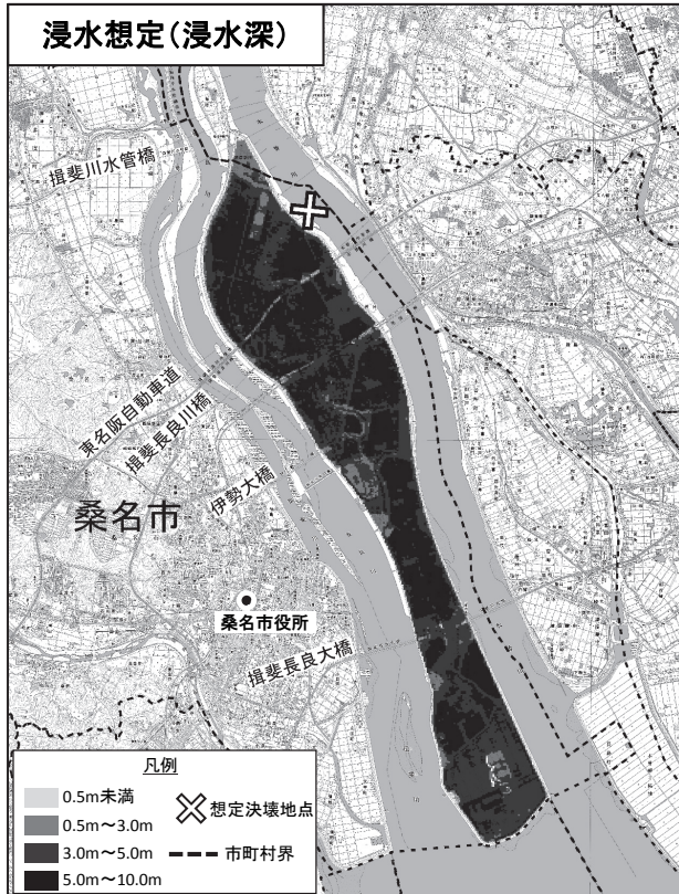
木曾川右岸10.8km地点決壊(63時間後)
