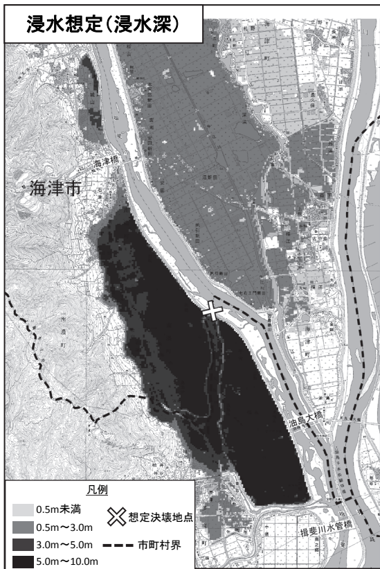
揖斐川右岸16.6km地点決壊(63時間後)
