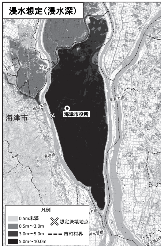
揖斐川左岸22.6km地点決壊(64時間後)
