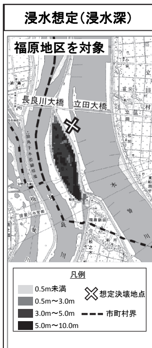
木曾川右岸13.6km地点 決壊(15時間後)
