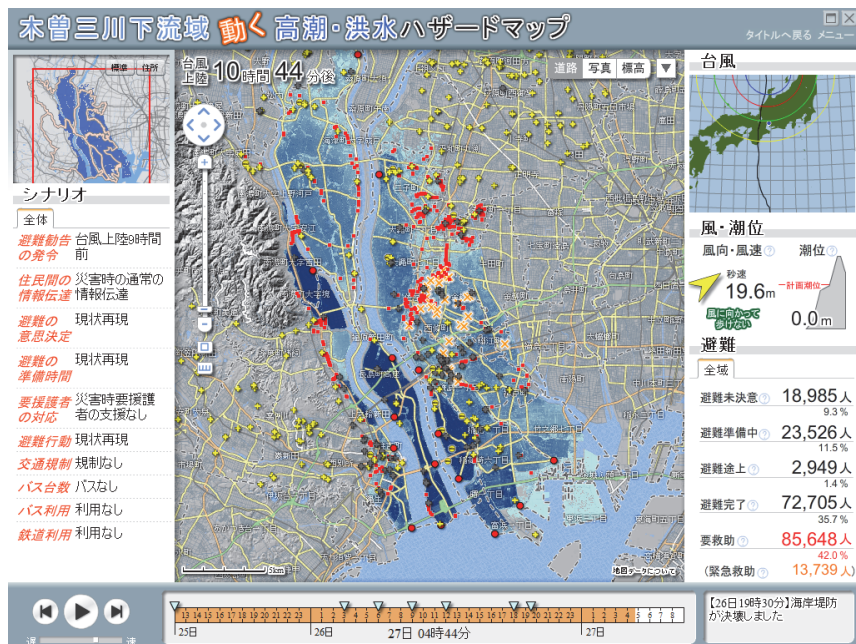
図 3-2 シミュレーションのイメージ（木曽三川下流域動く高潮・洪水ハザードマップ）
