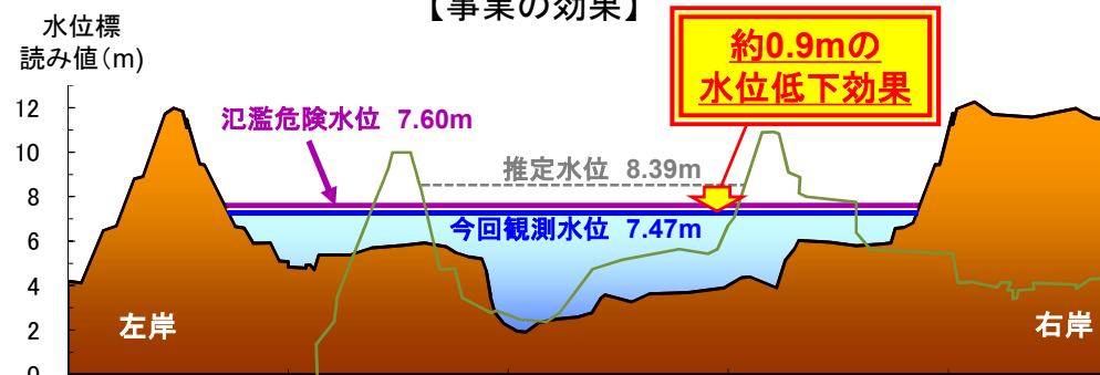
牧田川7.2kp付近 (緑線は河道拡幅前の河道断面:H2時点)
