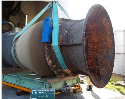
写真 新水門川排水機場の1号主ポンプ発錆状況
