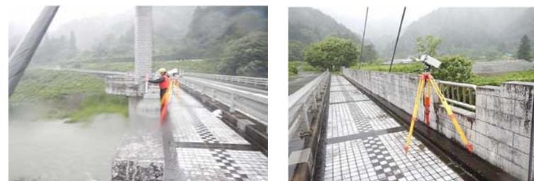
揖斐川・新杉原観測所における電波流速計による流量観測状況
