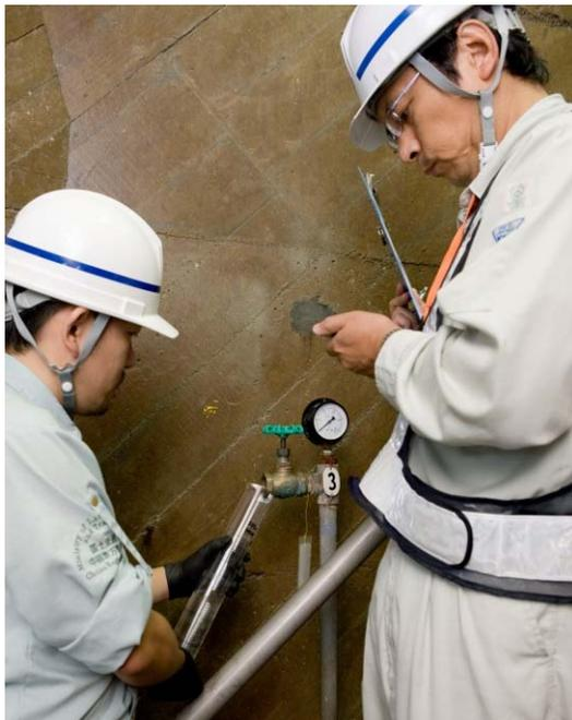
漏水量・揚圧力計測状況
