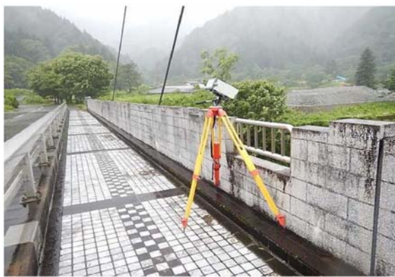
揖斐川・新杉原観測所における電波流速計による流量観測状況
