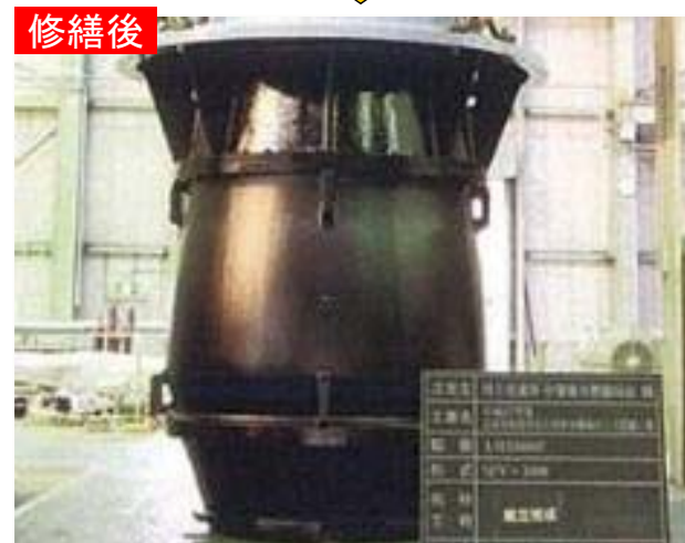
排水機場ポンプの補修状況
