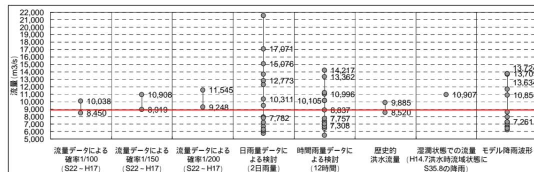
河道と洪水調節施設で対応できる量：8,900m³/s
