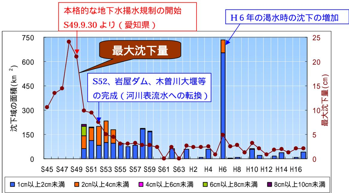
図 6.2.9 広域地盤沈下の最大沈下量と沈下域面積の変遷
