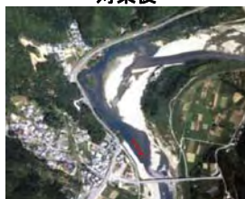
寄州の切下げ等による瀬・淵の再生事例 (北川河川激甚災害対策特別緊急事業)
