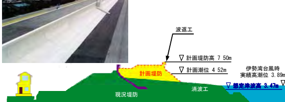
高潮堤防の整備
