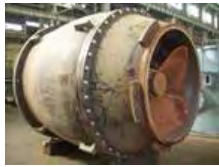
老朽化した排水機場の排水ポンプ (糸貫川天王川排水機場)
