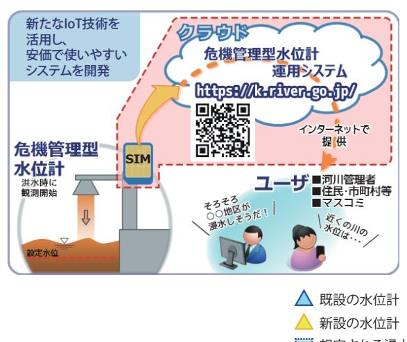
危機管理型水位計：設置箇所選定の考え方
