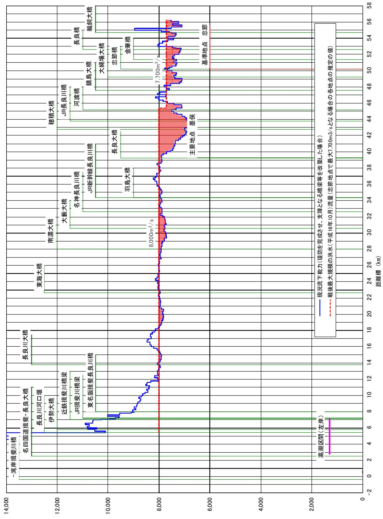
図-1.2.2 現況下能力と戦後最大規模の洪水流量の関係(長良川)
