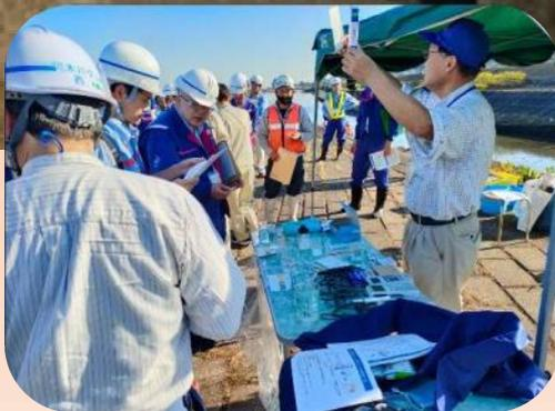
パックテストによる簡易水質検査
