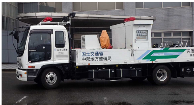
派遣した排水ポンプ車
