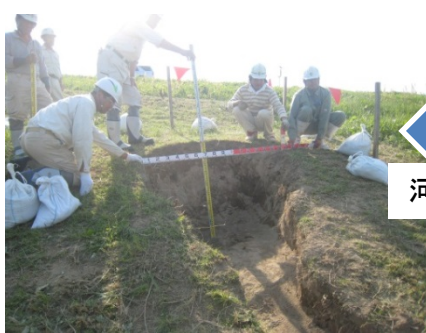
陥没の発見(詳細調査状況)
