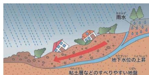
地すべりとは、土地の一部が移動する現象をいい、すべり面と呼ばれる地質の異なる面に沿って、上の土塊が滑動しようとする力と、抵抗力との均衡が地下水の作用によって破れた時に発生します。
