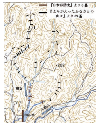
不動川上流の相谷に施工された明治時代の堰堤の概略配置図<出典:『日本砂防史』『よみがえったふるさとの山々』の記載をもとに国土地理院地理院地図を加工して作成>
