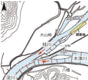
木津川・桂川合流部の水制護岸の設計図＜「木津川河床遺跡第22次発掘調査報告」の図を加工＞
