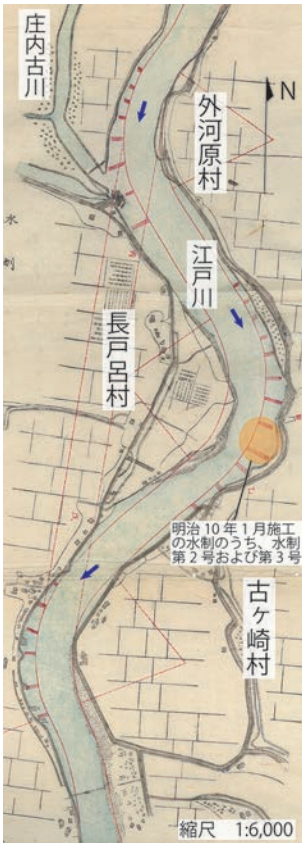
ドールンによる松戸の江戸川での「水刳ね」試験低水路設置図（『治水総論』より。一部加筆） ＜出典：土木学会附属土木図書館デジタルアーカイブス＞
