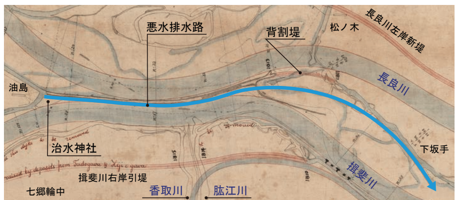
図1 油島から下坂手まで背割堤沿いに計画された排水路 〈出典：「木曾三川改修計画図（部分）」（宝光院蔵）に加筆〉
