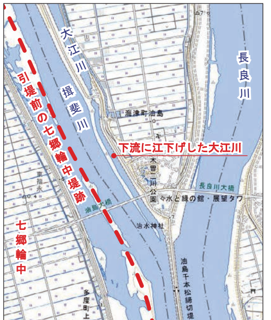
図5 増補工事による大江川導水堤 〈電子地形図25000（国土地理院）を加工して作成〉
