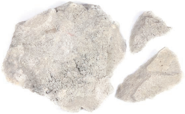
分析に使用したアンカーボルト周辺の「埋め込み材」
