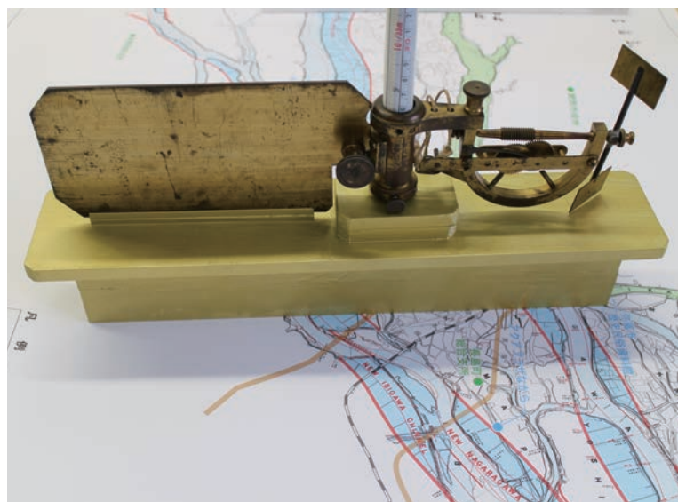
明治時代のドイツ製のプロペラ流速計（木曽川文庫蔵）
