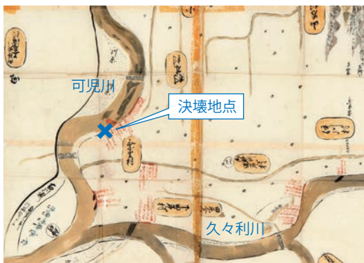
江戸時代の河川絵図に、決壊地点（広見地区）を記載。決壊地点付近、久々利川にも赤字で水制が記されている。 〈提供：可児郷土歴史館（伊香村絵図（部分））〉
