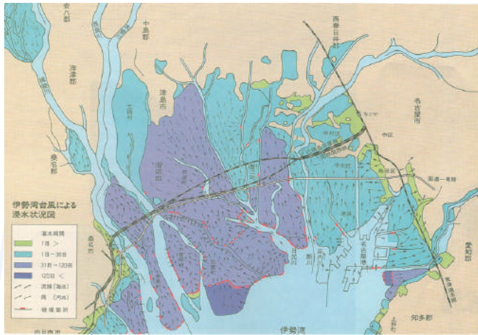
■ 伊勢湾台風による破堤箇所浸水状況
