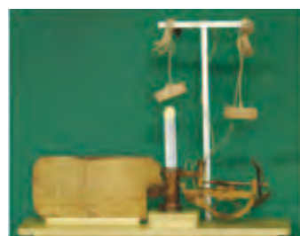
明治時代の流速計(波速儀) (写真③)
