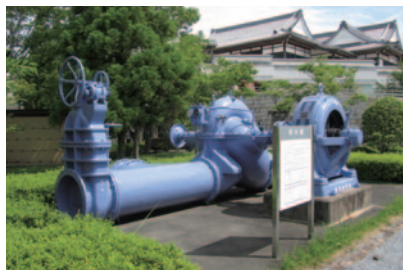
海津市歴史民俗資料館に展示されている福江排水機場の旧ポンプ
