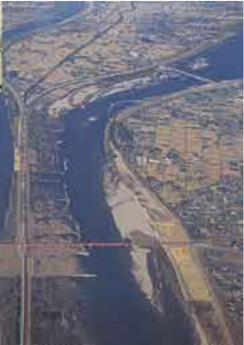
木曾川・長良川の背割堤、およびケレップ水制群写真集「空から見る木曾三川下流」より
