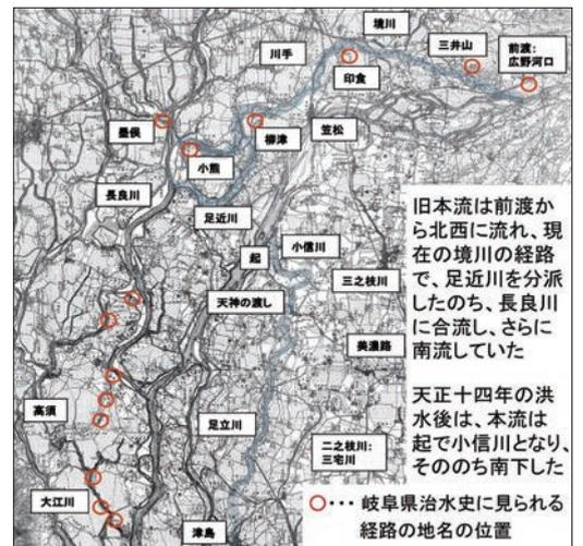
図-2 かつての木曾川本流の経路 (明治 22・24 年測図陸地測量部 5 万分の 1 地形図に加筆)
