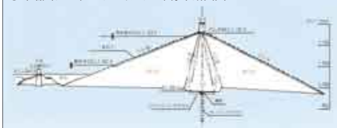
●味噌川ダム(ロックフィルダム)標準断面図
