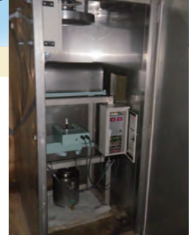
プラムライン ダムの変形、変位をプラムライン(懸垂線)を応用して測定する装置です。
