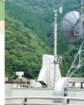
総合気象観測装置 風量計、雨量計、日照計を設置して、ダム管理に必要な気象情報を観測しています。
