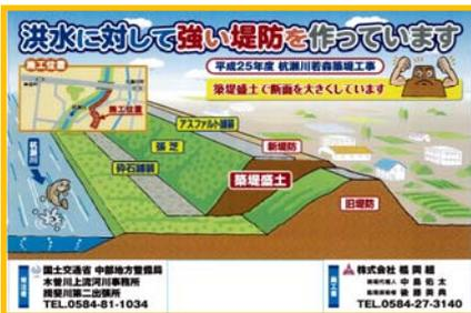
現在施工しております杭瀬川は、洪水対策の一環として堤防の補強工事を行っている地域であります。過去には洪水により周辺地域が浸水する被害も起きました。そういった災害を未然に防ぎ地域住民の皆様が安心して生活が送れるように、私達は洪水に強い堤防を造る為、杭瀬川左岸8.4k+73.3mより約300m上流へ、堤防断面を拡幅し堤防天端の嵩上による堤防補強工事を行っています。
