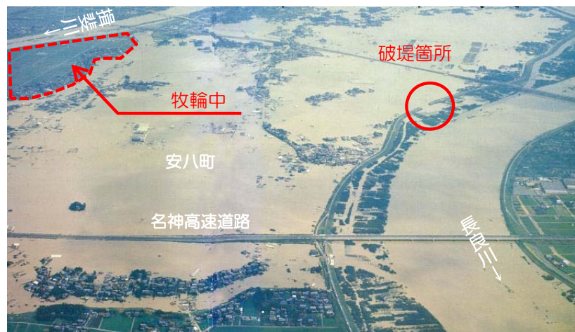
長良川破堤で浸水する安八町と浸水を逃れた牧輪中 （昭和51年9月洪水）
