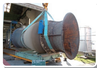
新水門川排水機場の 1号主ポンプ老朽化状況
