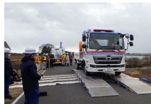
仮設ブリッジの上を通過する排水ポンプ車の様子(③)
