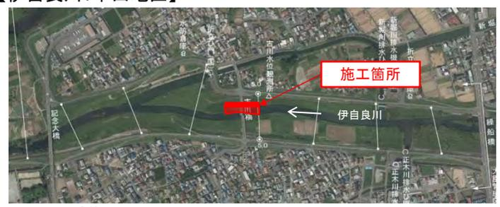
◆岐阜市木田地先にて洪水を安全に流下させるために河道掘削および低水護岸整備を継続して実施。
