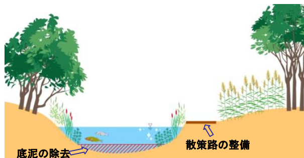
杭瀬川(4. 2k付近)再生イメージの断面図
