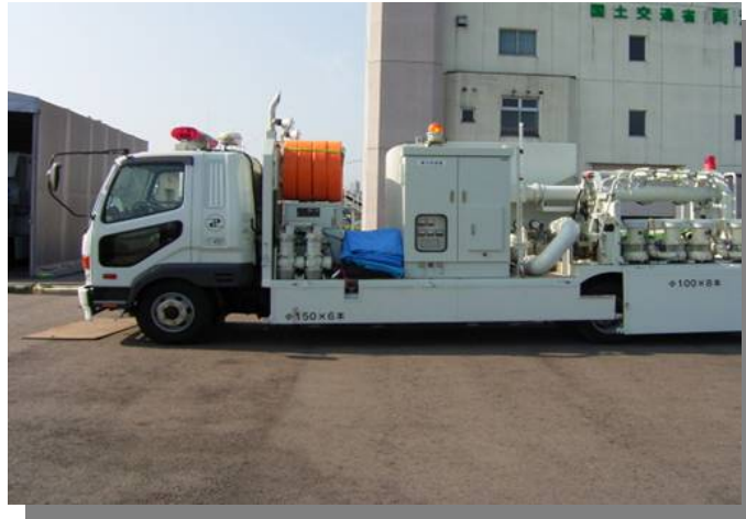
写真-3.5.2 排水ポンプ車（国土交通省木曾川上流河川事務所）
