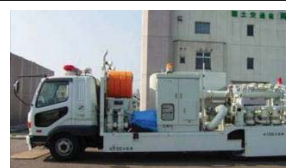
排水ポンプ車(0.5m 3 /s)
