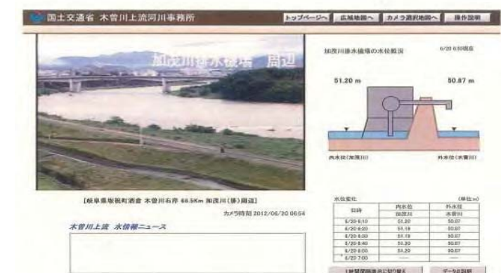
図- 3.6.1 量水標、CCTV設置イメージ
