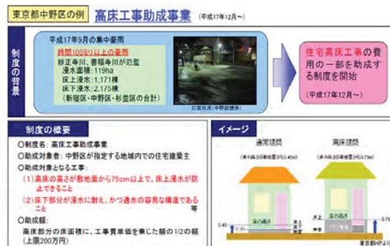
図- 3.6.11 嵩上げ工事への助成制度イメージ
