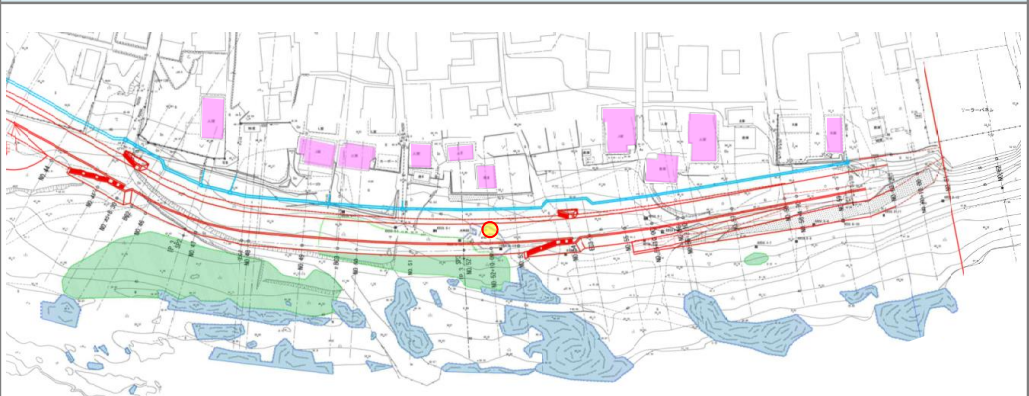
今回 川表に擁壁を設置
