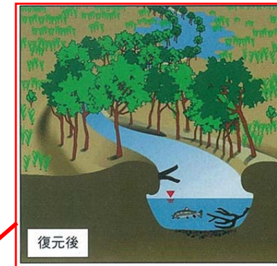
復元後 旧川の復元による直線河川の蛇行化
