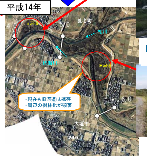
河川改修による河道の直線化 (杭瀬川4.0~6.0km付近)
