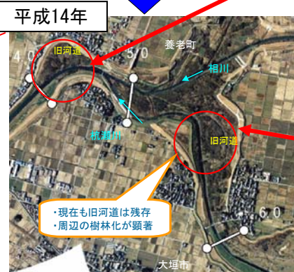
河川改修による河道の直線化 (杭瀬川4.0~6.0km付近)
