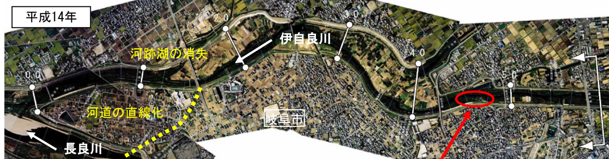
河川改修による河道の直線化
