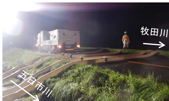
照明車及び排水ポンプ車稼働状況 (7月5日)
