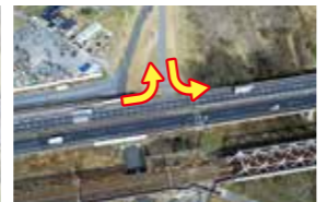
③ 名神高速道路と木曾川右岸堤防との接続 (平成30年3月完成) 木曾川右岸・羽島市
