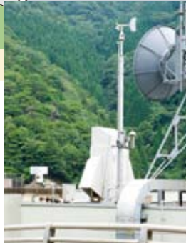
総合気象観測装置 風量計、雨量計、日照計を設置して、ダム管理に必要な気象情報を観測しています。
