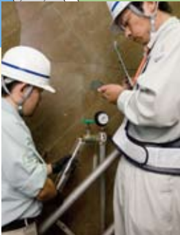
漏水計 ダム堤体内に設置した漏水計で、ダム堤体の漏水や湧水を測定しています。
