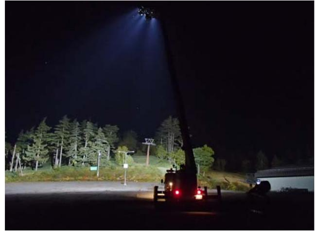
災害現場で夜間に十分な明るさを確保し、緊急作業の効率を高めるとともに、安全な作業環境を確保します。
