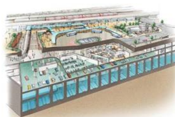
図：大曽根雨水調整池について（イメージ図）
