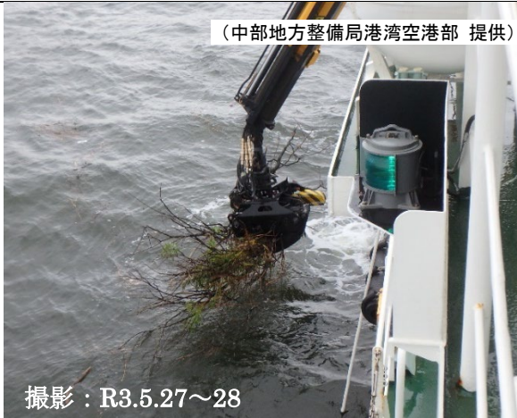
C-19 海洋環境整備事業 (海洋環境整備船 「白龍」による漂流ゴミ回収状況) クレーンによる流木の回収状況
